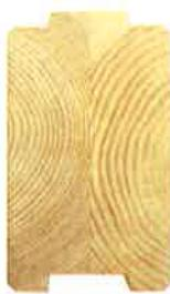
角ログは背合わせのラミネートログ。サネをひとつとし、両側の平面を大きくとって、座屈しにくくしている
